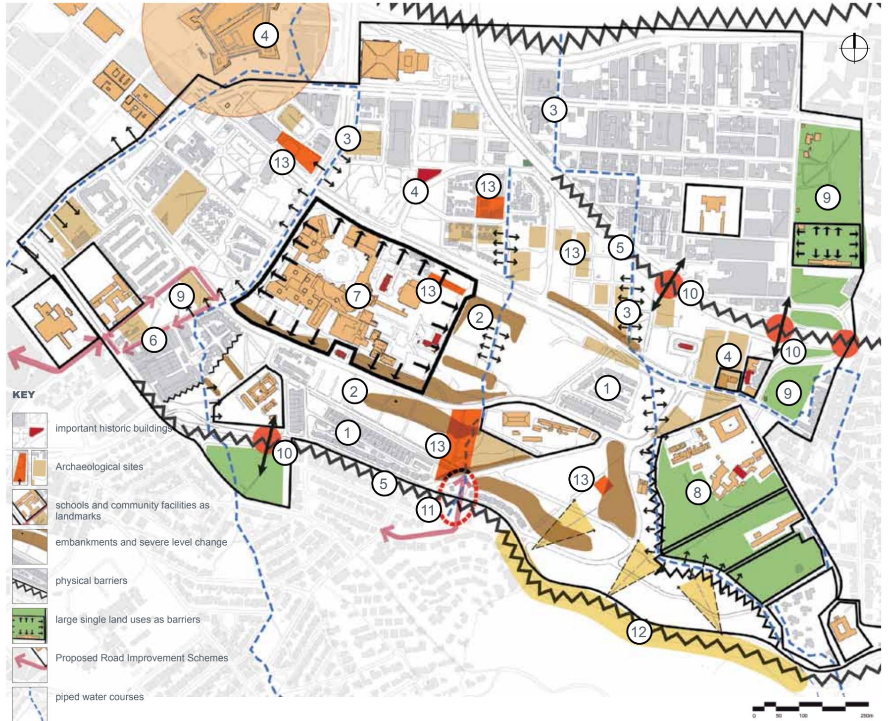
FIGURE 3.2 CONSTRAINTS PLAN
